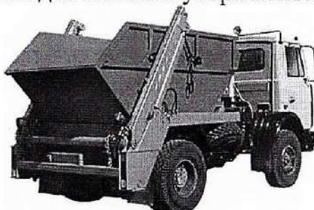
Рис. 4.16. Бункеровоз МКС-3501 на шасси МАЗ-5551А2
