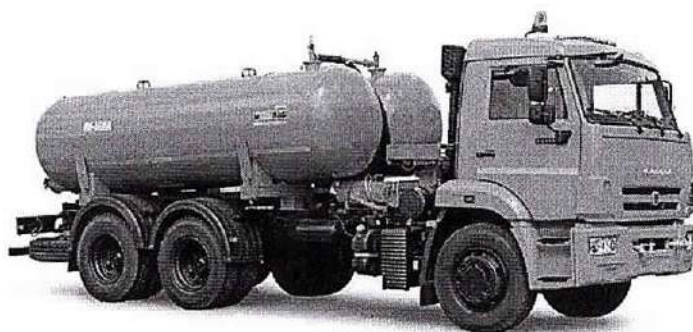
Рис. 5.1. Вакуумная машина КО-505А на шасси КамАЗ-65115-71
