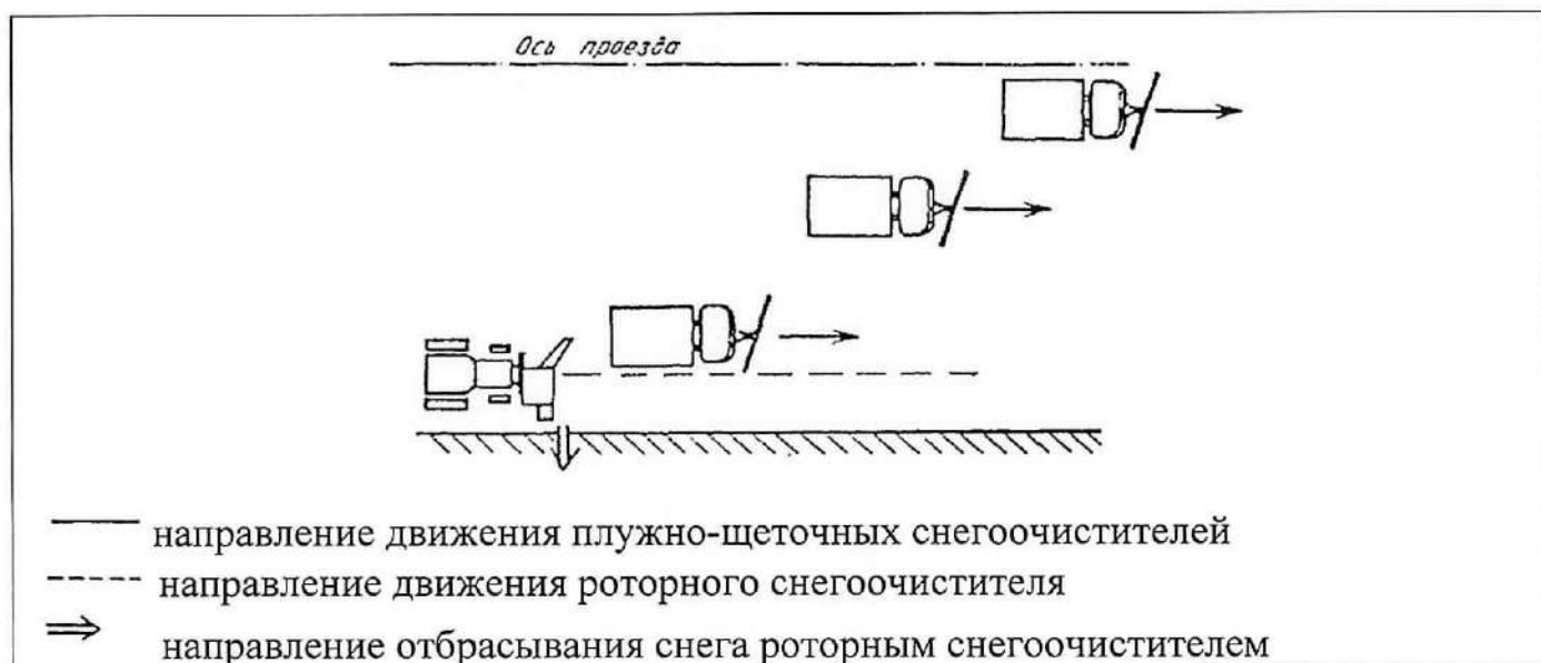
Рис. 6.6. Схема расчистки проезжей части улиц колонной плужно-щеточных снегоочистителей и перекидывание снега роторным снегоочистителем
