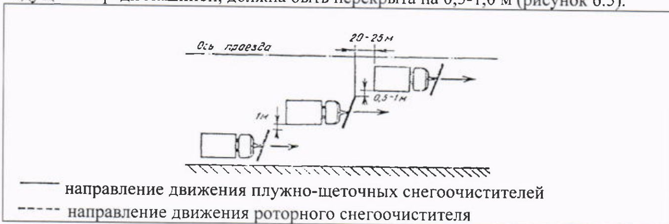
Рис. 6.5. Схема расчистки проезжей части улиц колонной плужно-щеточных снегоочистителей и складирование снега в лотке
